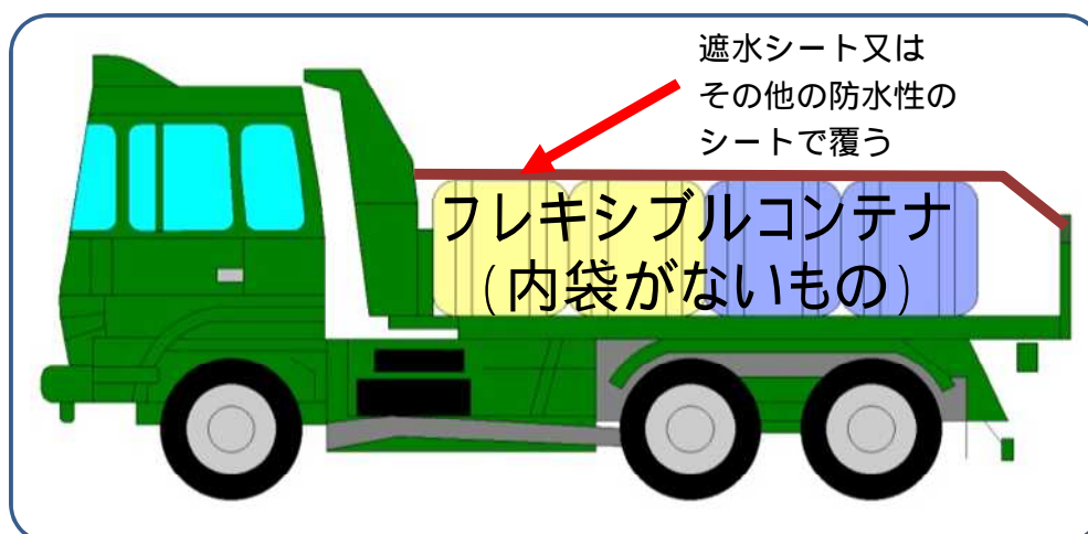
図 3-10 フレキシブルコンテナと遮水シートを組み合わせた運搬（例）
