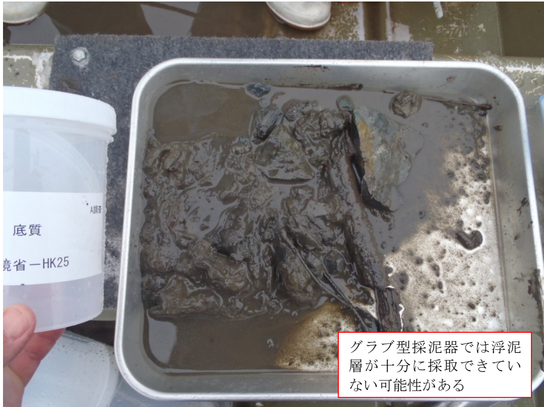
写真 3.3.4 はやま湖湖底 No.25 におけるグラブ採泥試料 (採取回数：3回、採泥厚：3cm、Cs-137：750Bq/kg)
